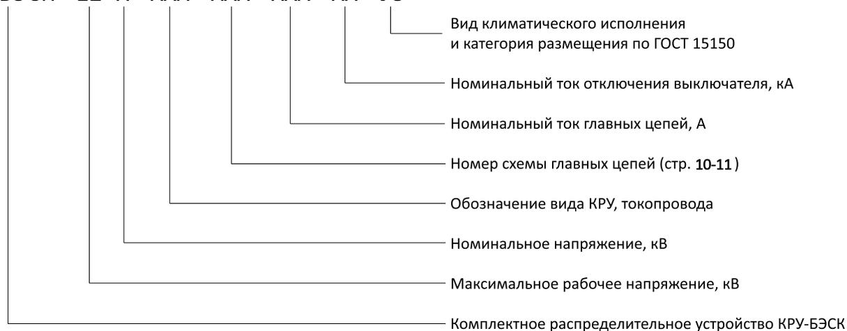
Буквенное обозначение вида шкафов КРУ, токопровода в зависимости от встраиваемой аппаратуры:
