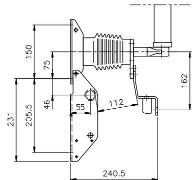
Заземлитель с возможностью включения типа E12, устанавливаемый на выключателе нагрузки NAL 12
